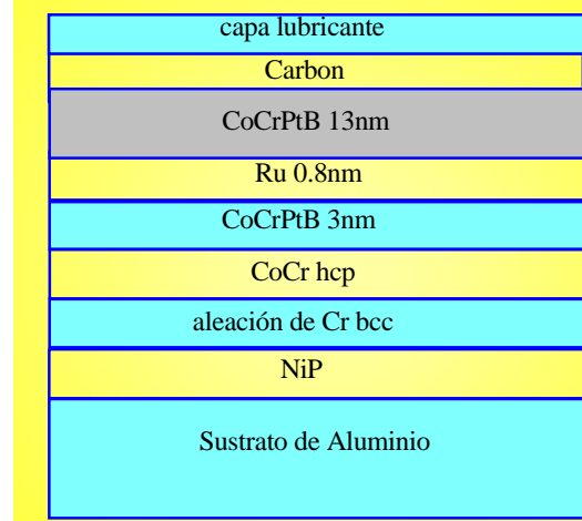
Figura 4. ESQUEMA DE UNA MULTICAPA UTILIZADA COMO MEDIO EN UN DISCO RÍGIDO MAGNÉTICO.
