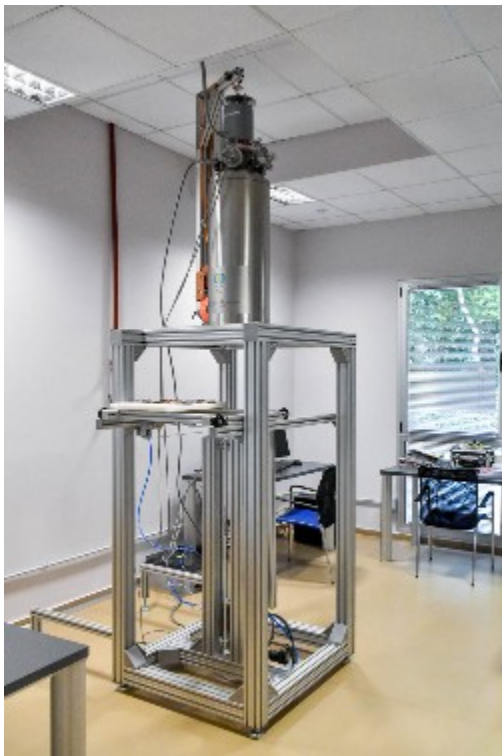
Figura 2: Fotografía del magnetómetro en su sitio de operación en la provincia de Salta (izquierda). A la derecha se observa la grilla móvil cargada con dos lotes de muestras a ser medidas (crédito imágenes: La.Te. Andes S.A.).
