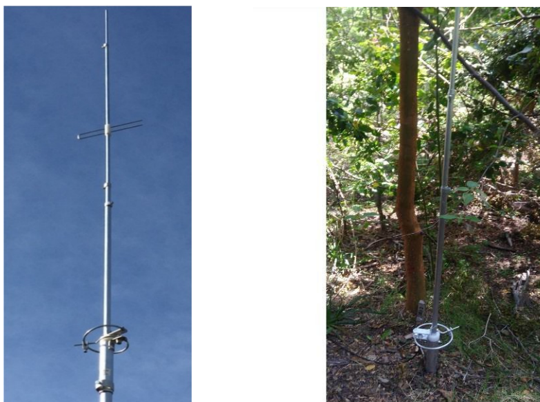
Figura 2. Antena omnidireccional fija para 150MHz. Se incluye la imagen de la antena ubicada en una de las estaciones de recepción en el bosque del Llao Llao (derecha).
