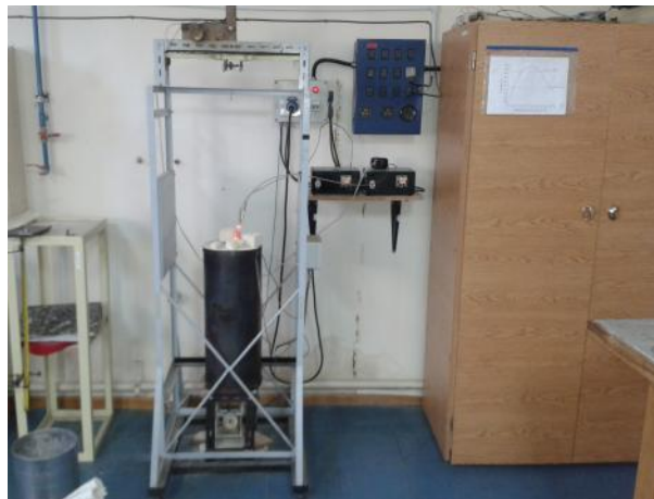
Figura A1 - Horno 1, fijo al piso y con sistema mecánico de desplazamiento de la varilla.
