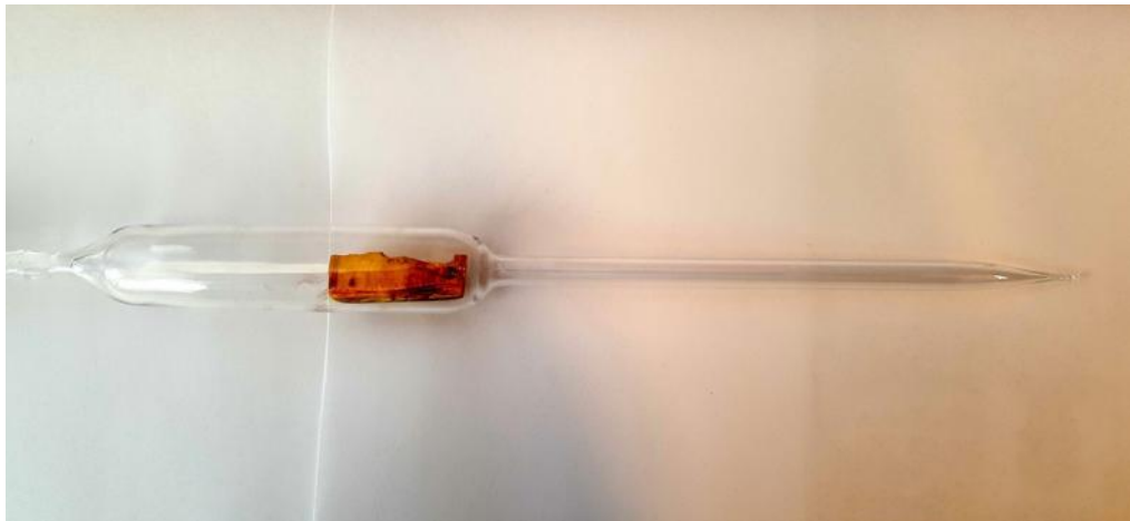
Figura 3 – Aleación de CuZnAl encapsulada y lista para la fabricación del monocristal. La aleación se encuentra en la sección de mayor diámetro de la capsula.
