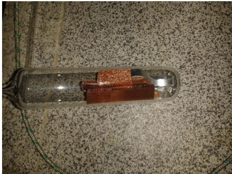
Figura 2 – Cu, Zn y Al encapsulados en un tubo de cuarzo, bajo atmósfera de Ar.
