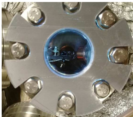
Fig.7: izq.) Dispositivo montado en un viewport de una cámara de ultra alto vacío. En el interior se observa el portamuestras. der.) vista del interior de la cámara.
